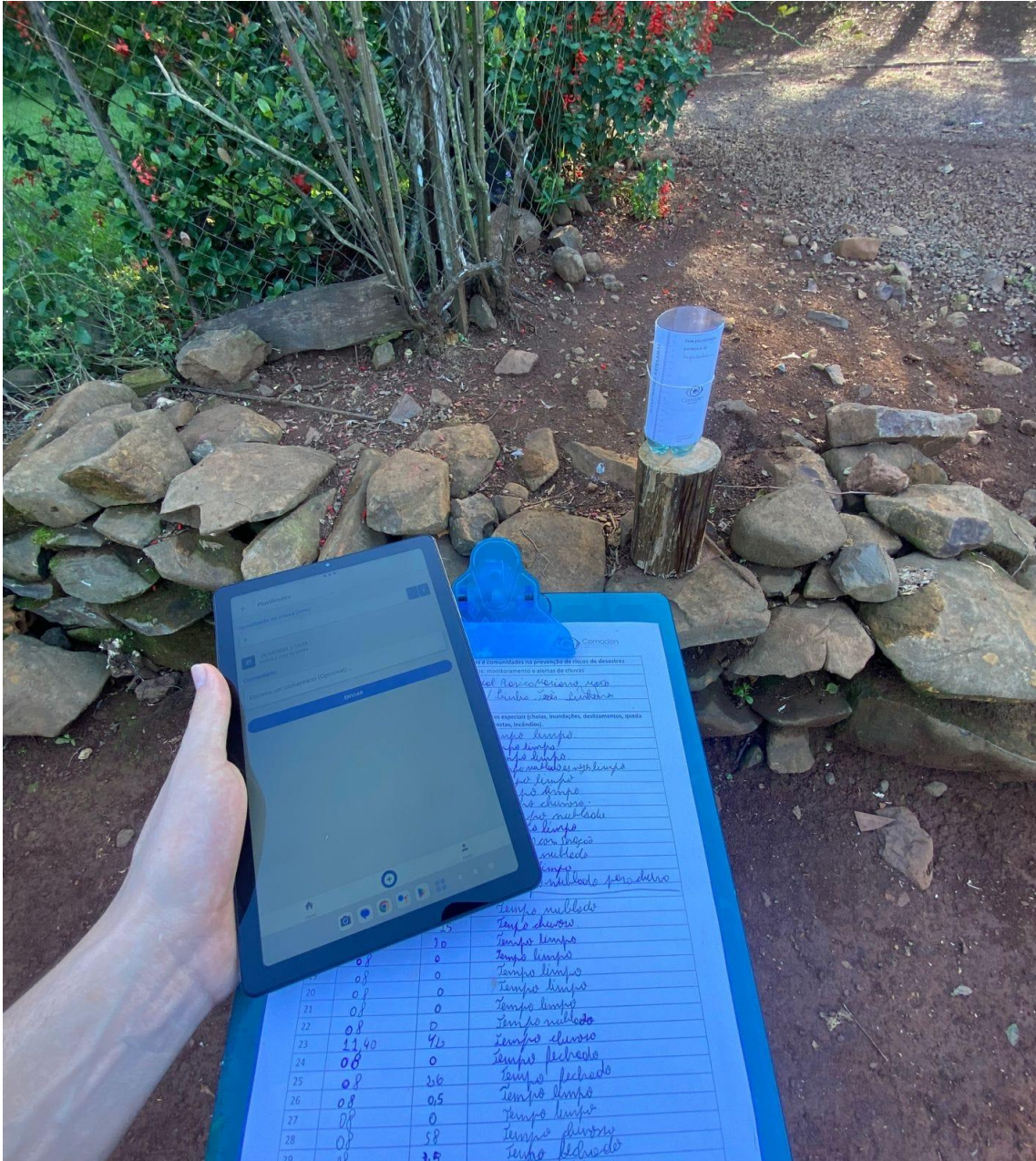
Figura – Coleta de dados no pluviômetro artesanal e registro dos dados no Aplicativo Dados a Prova d'água.
