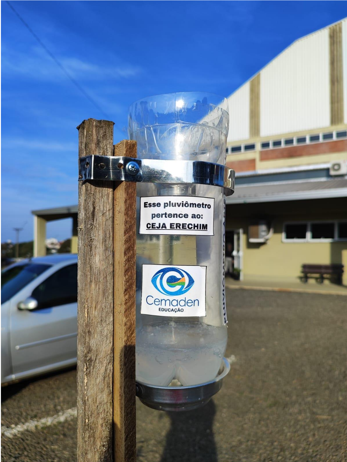
Figura – Pluviômetro implantado nas escolas.
