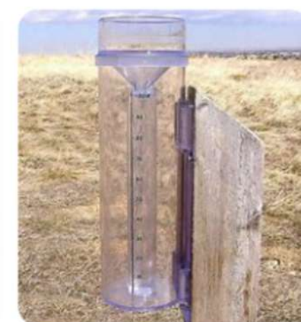
Medidor de chuva Stratus com capacidade de 28...
