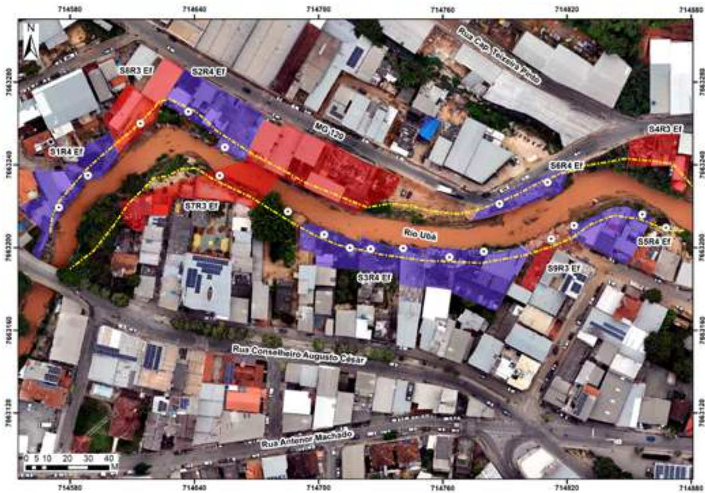
Figura 36 – Exemplo do resultado de mapeamento e setorização de risco para processos de erosão fluvial (Ef) / solapamento em um trecho do Rio Ubá no município de Ubá – MG.
