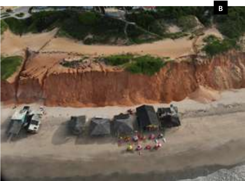
Figura 72 – Dinâmica multitemporal de processos em falésias na Praia de Canoa Quebrada, Aracati/CE: evidências de queda de blocos e deslizamentos (A); evidências de processos erosivos e deslizamentos (B e C).
