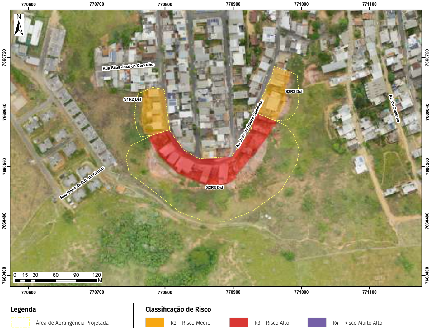
Figura 84b – Exemplo de classificação do risco de deslizamento em um trecho do município de Muriaé/MG. Clas-sificação do Risco (A) e Classificação do Risco com a indicação da área de abrangência projetada (B).
