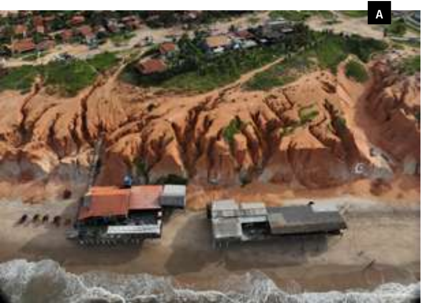
Figura 72 – Dinâmica multitemporal de processos em falésias na Praia de Canoa Quebrada, Aracati/CE: evidências de queda de blocos e deslizamentos (A); evidências de processos erosivos e deslizamentos (B e C).
