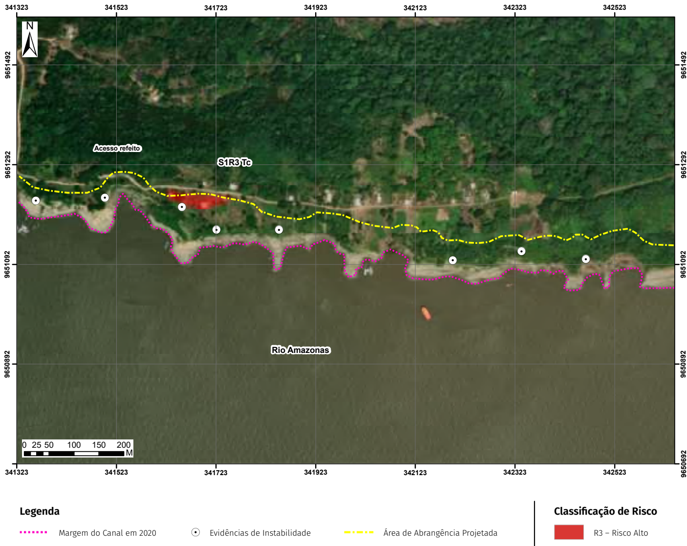
Figura 38 – Exemplo do resultado de mapeamento e setorização de risco para processos de Terras Caídas (Tc) em um trecho do Rio Amazonas.
