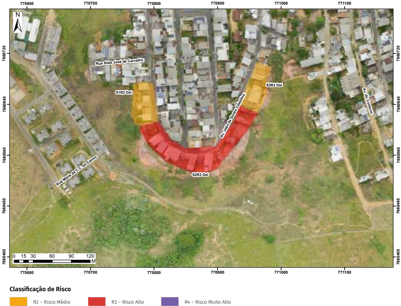
Figura 84a – Exemplo de classificação do risco de deslizamento em um trecho do município de Muriaé/MG. Classificação do Risco (A) e Classificação do Risco com a indicação da área de abrangência projetada (B).
