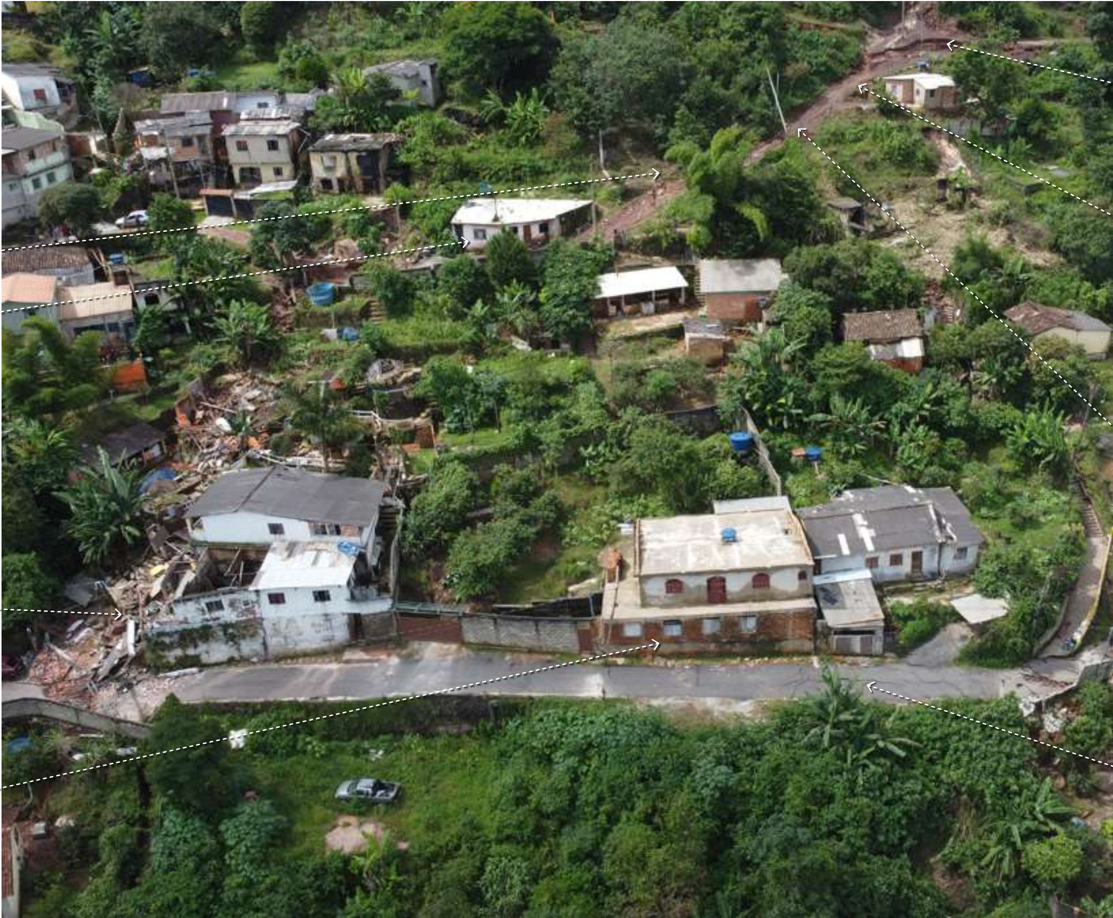
Figura 49 – Processo de ras- tejo no Bairro Taquaral em Ouro Preto/MG.
