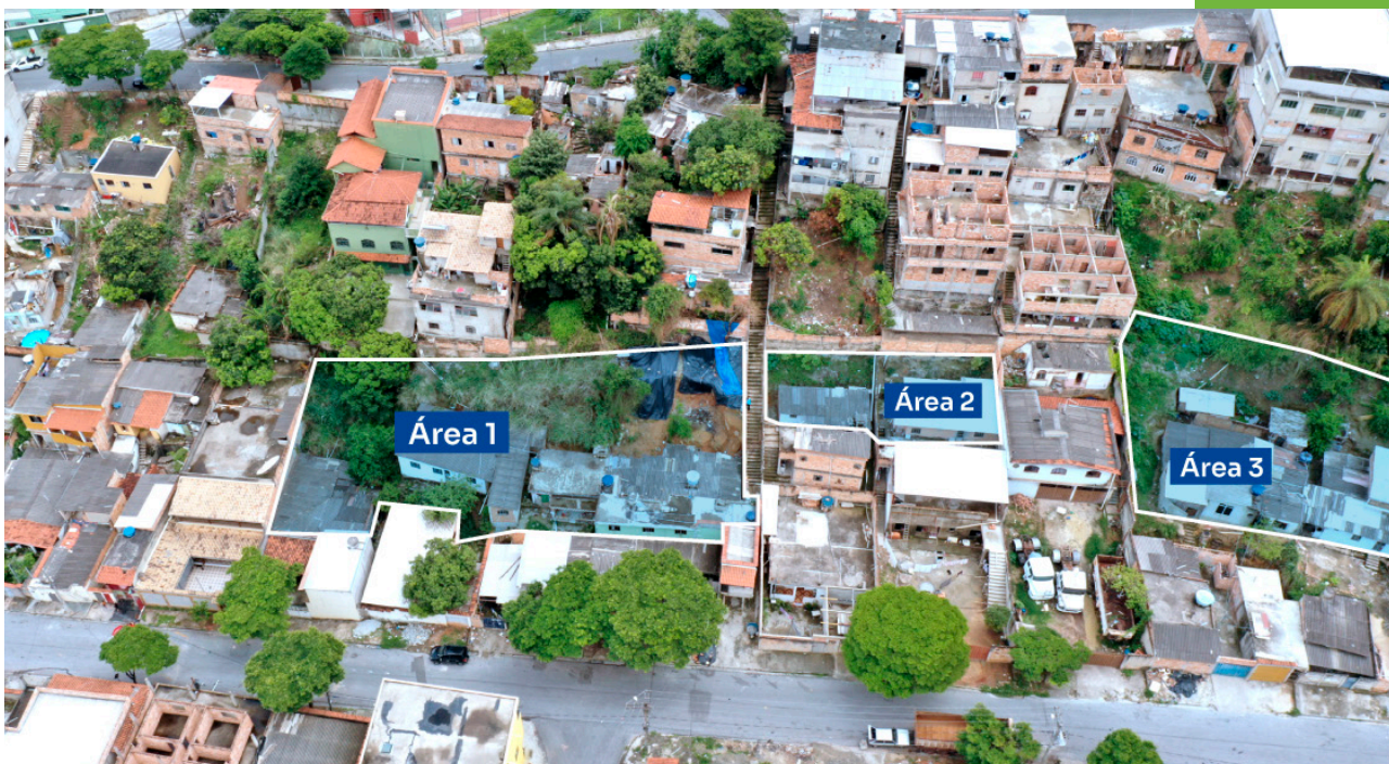
Figura 9. Exemplo de interpretação de foto oblíqua de Ibirité - MG, com pré-setorização de pontos críticos para o mapeamento do risco na escala de detalhe.
