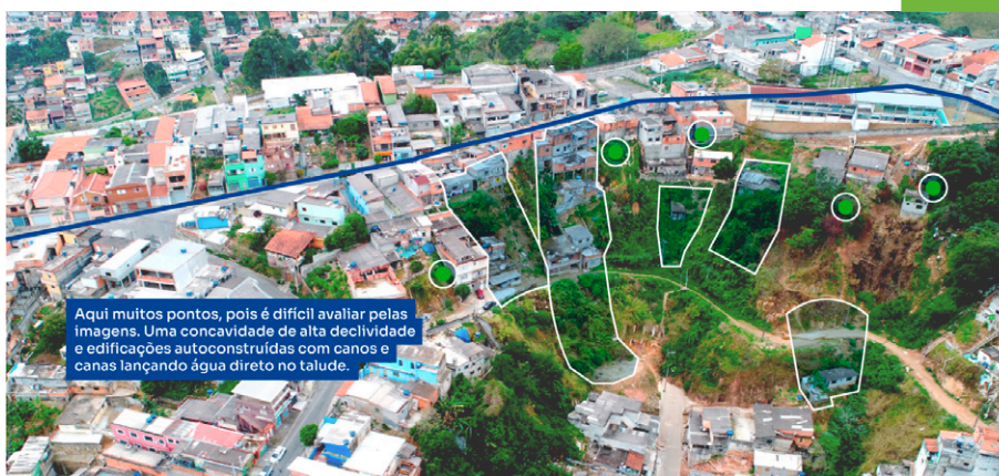
Figura 8. Exemplo de foto oblíqua de Franco da Rocha, com pré-setorização e pontos críticos observados em escritório que permitem organizar o roteiro de campo e otimizar a investigação em escala de detalhe.
