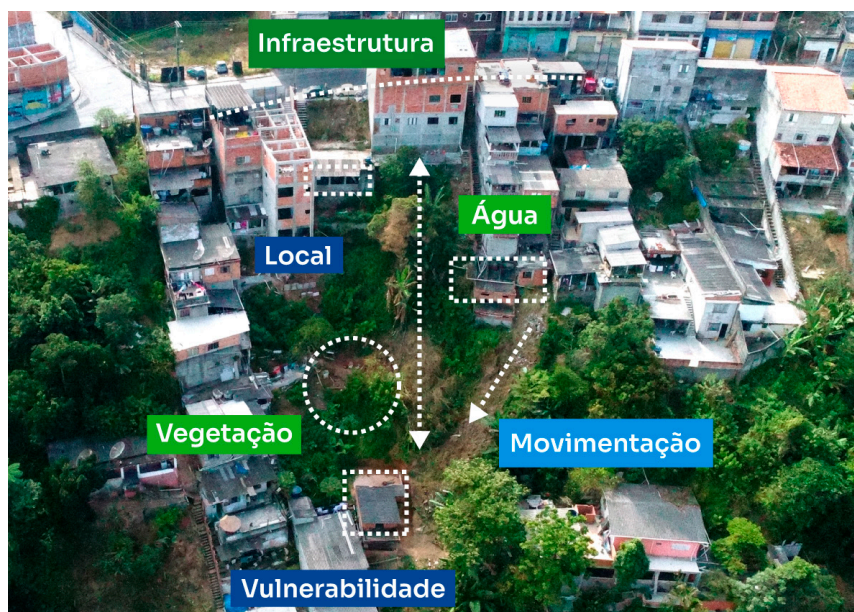
Figura 6. Exemplo de elementos observáveis em campo para caracterização de um setor de risco.
