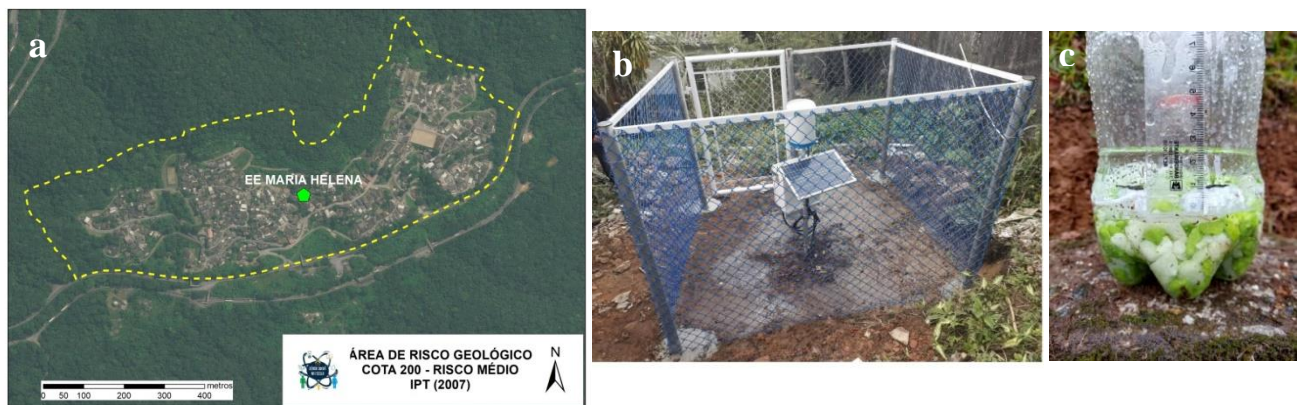
Figura 1 – (a) Mapa do Bairro Cota 200/área de risco geológico e localização da EE Maria Helena Duarte Caetano em Cubatão-SP. (b) Imagem do pluviômetro automático EE Duarte Caetano do Cemaden localizado na escola. (c) Imagem do pluviômetro PET.
