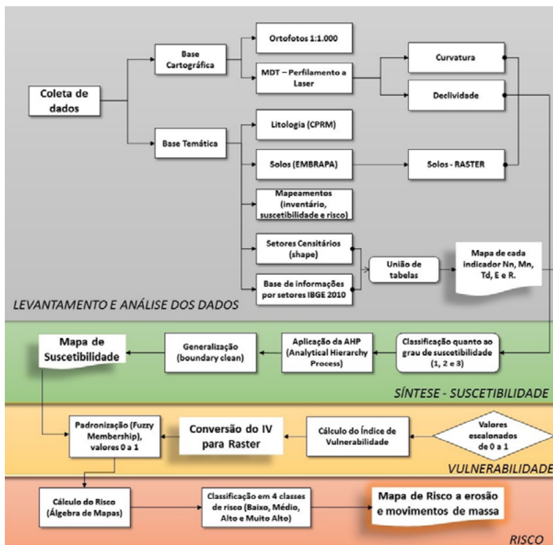
Figura 2: Fluxograma metodológico para o mapeamento do risco a movimentos de massa no município de Garanhuns
