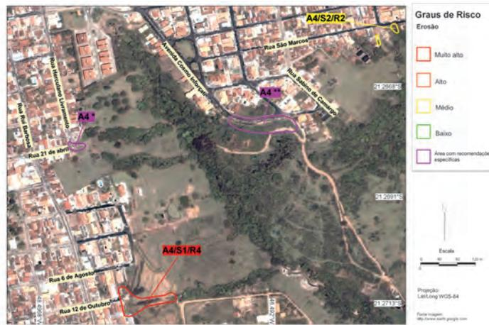
**Figura 10.6** - Mapeamento de risco associado a erosão no município de Monte Alto, SP: (a) Setorização e classificação das áreas de risco (IG, 2008); (b) detalhe do evento de erosão ocorrido em 2007 (Fonte: Acervo IG, 2007).
