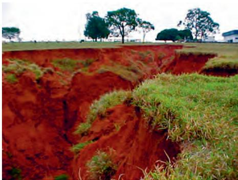
**Figura 4.2** - Processo erosivo na forma de boçoroca, na cidade de Rancharia - SP. (Fonte: Arquivo IG, 2001)
