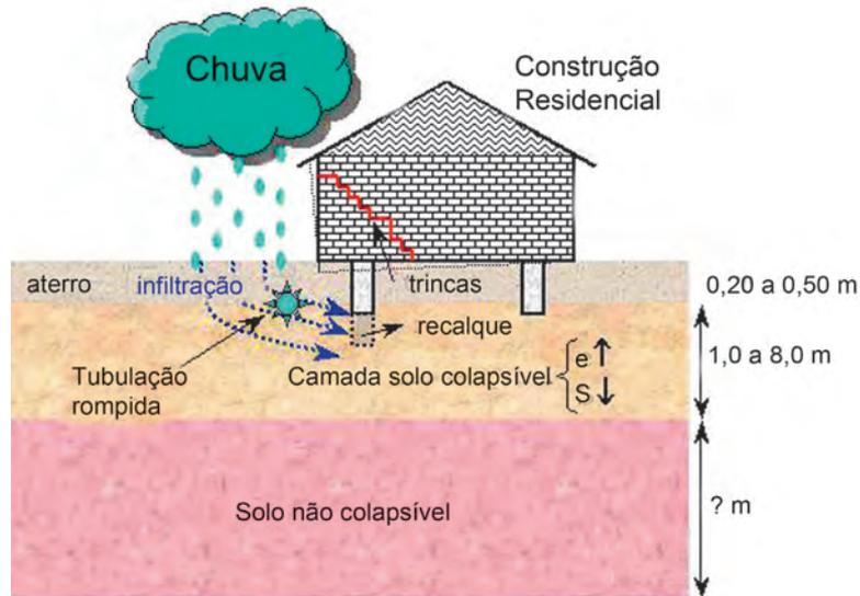
**Figura 6.7** - Modelo simplificado de ocorrência de recalque por colapso de solo (Nota: “e” é o índice de vazios do solo e “S” é o grau de saturação do solo).
