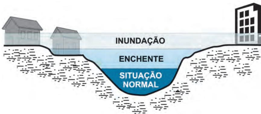
Figura 3.1 - Perfil esquemático do processo de enchente e inundação (Fonte: Min. Cidades/IPT, 2007).
