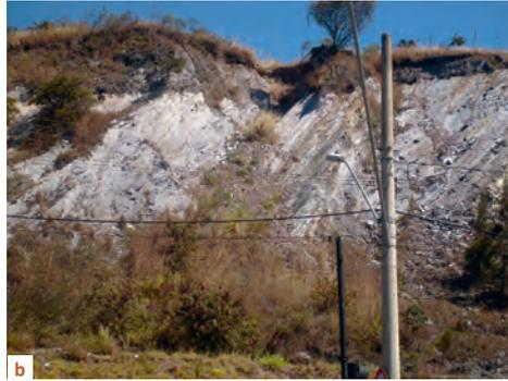
Figura 2.5 - Escorregamento em cunha em: (a) Quartzo em Rio Acima, MG; (b) Talude em filito alternado com quartzo da Formação Cercadinho em Belo Horizonte, MG. Fonte: Parizzi, 2004.
