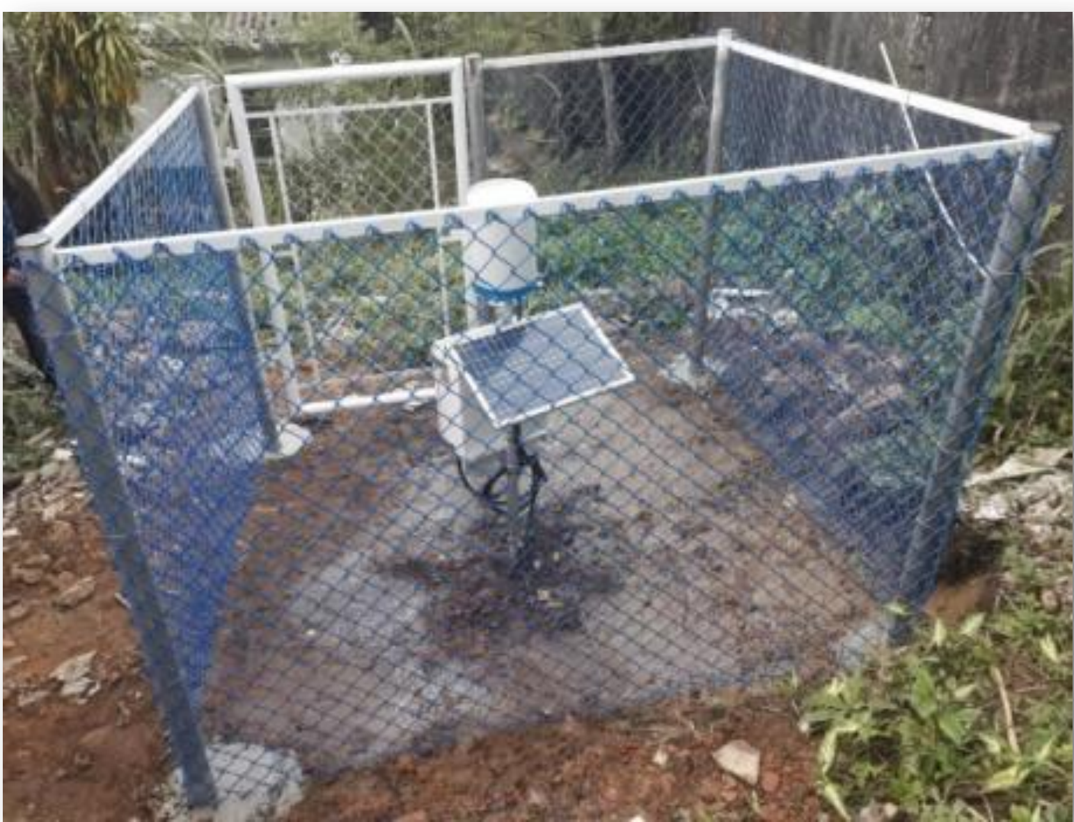
Figura 2 - Imagem do pluviômetro automático EE Duarte Caetano do Cemaden localizado na escola de mesmo nome no Bairro Cota 200.
