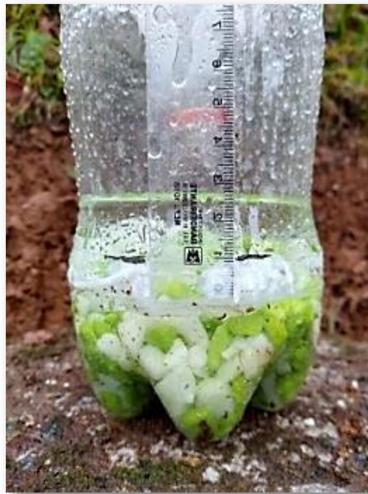
Figura 3 - Imagem do pluviômetro PET localizada na moradia da jovem pesquisadora no Bairro Cota 200 a 278 m de distância da PCD Geo do Cemaden.
