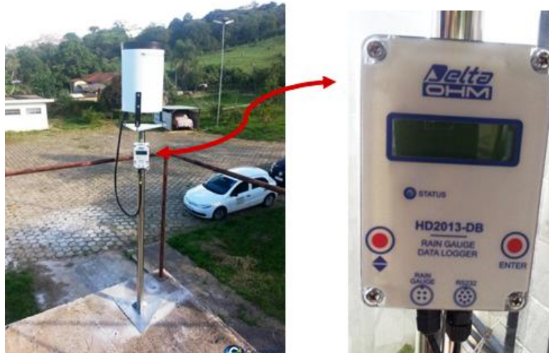
Detalhe do visor digital de um pluviômetro semiautomático.
