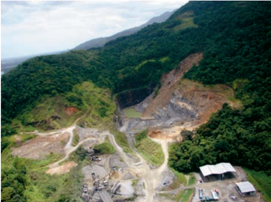
Vista aérea de uma mineração em atividade em Cubatão. No lado direito, um escorregamento atinge a cava. (Dezembro de 2008). Foto: Acervo IG.
